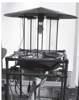
図-1 使用ライトトラップ (4面透明ガラス水盤付)
