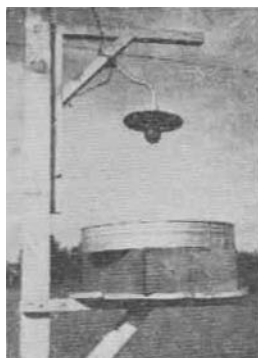
ホクト電球工業株式会社製青色電球 100W (連続スペクトル 6300 Å~3180 Å)
