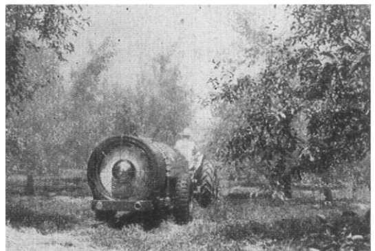
スピードスプレーヤ（形式SS-1A）による リンゴ園の薬剤散布
