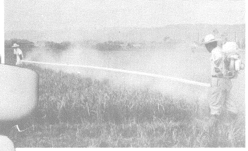
40mのパイプダスタによる水田防除
