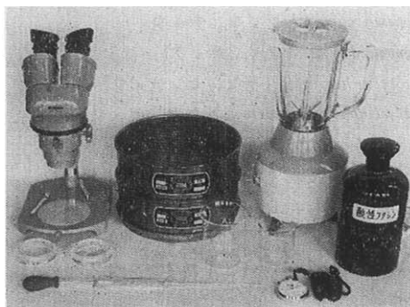
第1図 ミキサー・ふるい別け法 (BAINES 法) に必要なおもな器具 (上), と分離したミカンネセンチュウの雌虫の検鏡に用いるシラキウス皿 (下), (点線内を数える)
