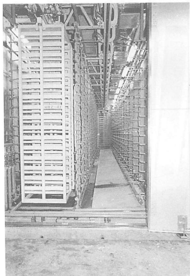
図-3 幼虫室内部 中央と壁面のノズルから各バットに散水し、老熟幼虫の跳び出しを刺激する。跳び出した幼虫は床面に水を張って受ける。
