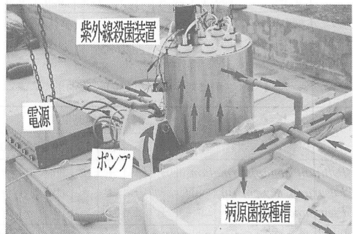
図-3 流水殺菌灯を用いた紫外線殺菌装置と小型の水耕栽培装置への接続 殺菌装置は容量約 35 l で、9 本の流水殺菌灯とかくはん用のポンプが設置されている。ステンレス製で、密閉可能である。
