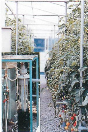
▲紫外線・オゾン処理装置による防除実験
