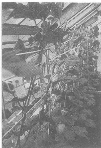
図-2 電線電極（コロナ帯電）を設置した状況
