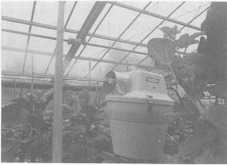
図-5 ハウスメロンに対する静電散布状況 (1,100 m 2 )
