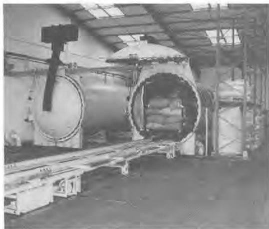
写真-1 高圧炭酸ガスによる害虫駆除処理を終えたハーブ入りの袋が、高圧釜から電動貨車によって搬出されるところ。
