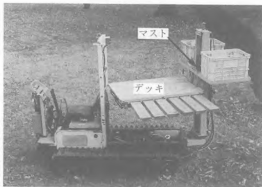
図-8 高所作業用デッキ
