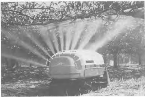
図-11 ノズル回転式防除機（スイングスプレーヤ）
