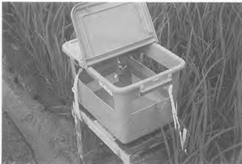
図-3 新潟県で供試したフェロモントラップ (25 cm×35 cm×高さ 25 cm のポリ容器)
