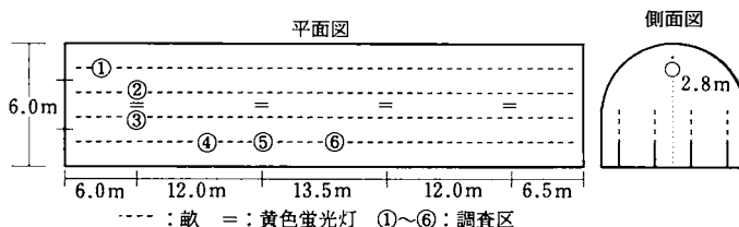
図-1 黄色蛍光灯設置カーネーション施設概略図
