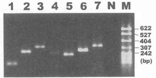
図-3 プライマーによる増幅効率の差:CEVdに対するRT-PCR増幅産物のアガロースゲル電気泳動(臭化エチジウム染色像)
