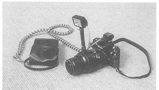
図-1 ニコンFE2にマイクロニッコール105 mmとストロボSB-15(ヘッドをはずしてコードでつないである)を取り付けた状態
