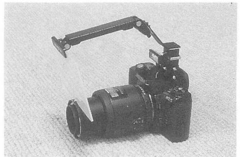
図-4 ペンタックスMZ-5にマクロ50mmとミノルタのディフューザーC■-1000を改造して取り付け、内蔵ストロボを撮影状態にしたところ
