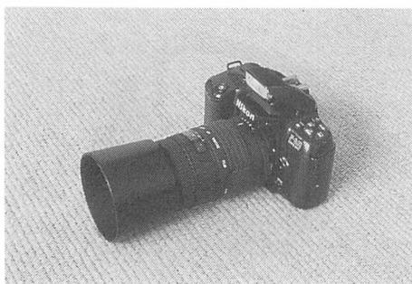
図-2 ニコンF 601 にシグマのマクロ 180 mm を取り付け内蔵ストロボを撮影状態にしたところ
