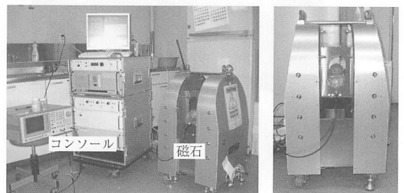
図-6 「さんさ」の計測に用いた MRI (共鳴周波数 8 MHz, 検出器幅 9 cm)
