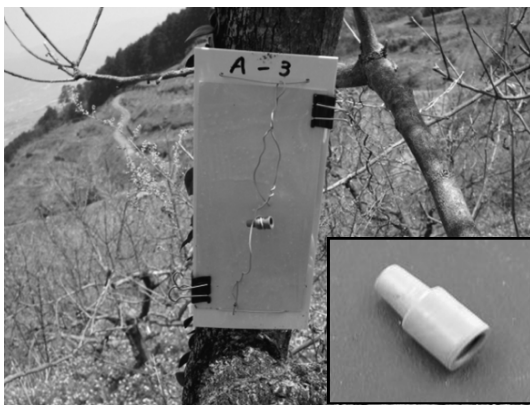
図-5 粘着トラップを用いた生物検定 (野外試験) の様子 (右下はゴムセブタム)
