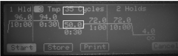
図-8 PCR の温度条件例 白い四角で囲んだところはプライマーによって温度が変わる。
