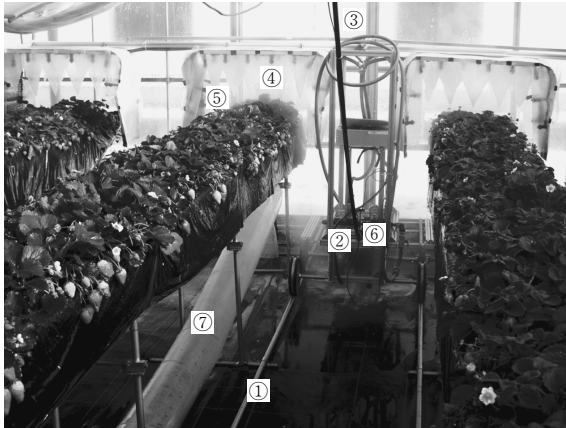
図-4 自走式温湯散布装置 (愛称: ゆけむらー)
