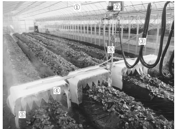
図-5 懸垂自走式温湯散布装置 (愛称: 懸垂ゆけむらー)
