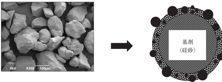
図-3 微粒剤 F の SEM 写真と製剤の構造
