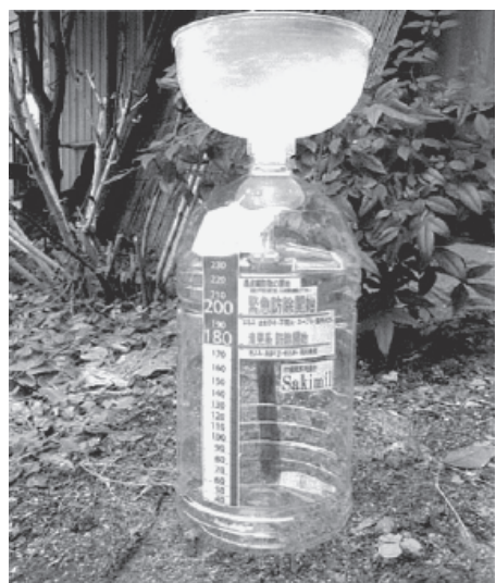
図-1 薬剤散布後の累積降水量を計測するための雨量計 （株）一色本店社製。
