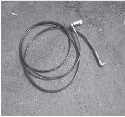
図-3 ボンベの噴射口に連結ネジで専用の耐圧パイプおよびノズルを接続する 連結ネジ内には必ずパッキンを入れる。
