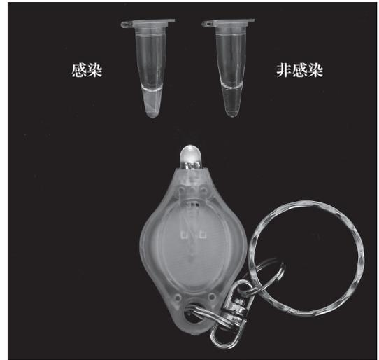
図-1 キーホルダー型 UV-LED ランプを用いた判定
