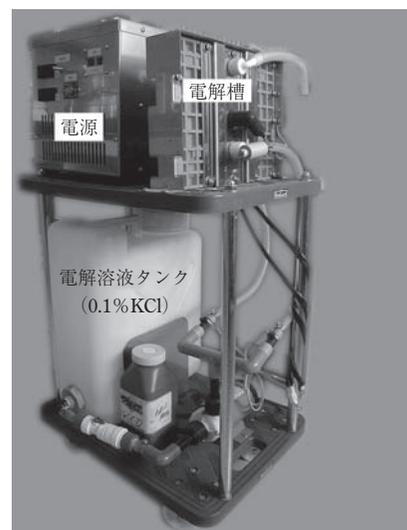
図-1 ホシザキ電機(株)製酸性電解水調整装置
