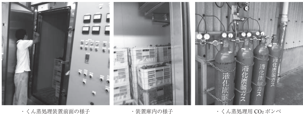
図-3 高濃度 CO 2 くん蒸処理装置 茨城県つくば市 農研機構 果樹研究所内設置。
