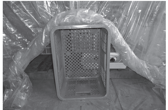
図-6 排気時における吸気口の設置状況
