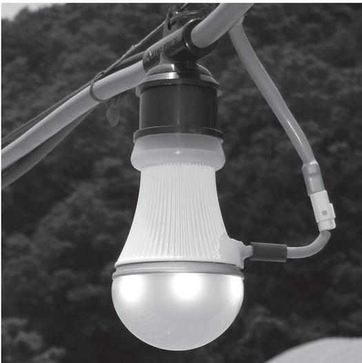
図-8 試作した LED ランプ (AC100 V 対応)
