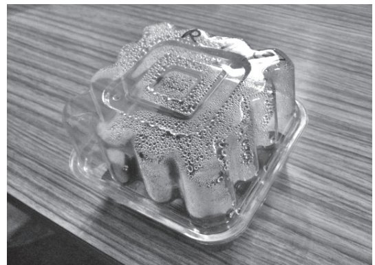
図-2 プラスチック容器内で湿室に保った状態
