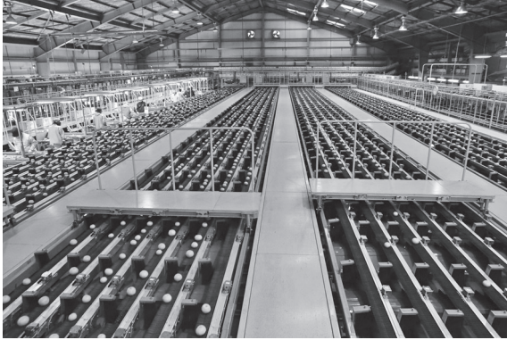
JA みっかびの選果場：最新鋭の光センサーにより糖度を、またカラーグレーターにより大きさ、形状、概観などを測定し、みかん一つ一つを選別、自動的に箱詰め
