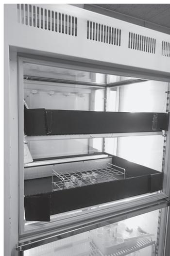
図-4 恒温器内の照射装置
