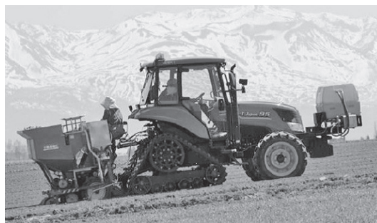
図-3 インファローアプリーケーター搭載トラクター
