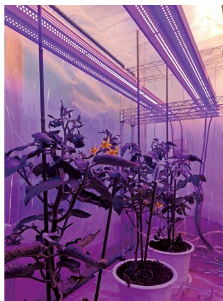
図-4 トマトハモグリバエに対する青色光殺虫のポット試験の様子
