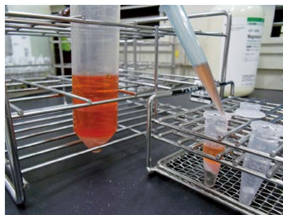
図-5 塩析後の試料 (左側) と d-SPE 精製後の試料 (右側) 抽出液は塩の作用により、遠心管内でアセトニトリル層 (上層) と水層 (下層) に分離する。アセトニトリル層をマイクロチューブに採取し、精製を行う。
