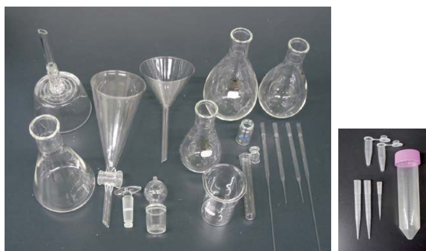
図-2 残留農薬分析に使用する器具 左：従来法，右：QuEChERS 法。
