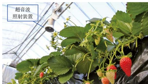
図-1 超音波照射によるイチゴの病害防除試験
