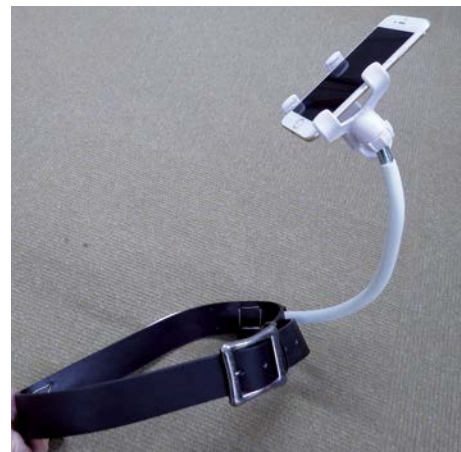
図-1 スマートフォンを胸の前に配置するためのフレキシブルアーム
