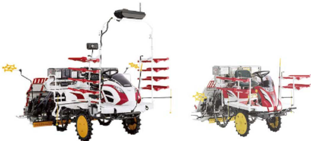
図-2 密苗仕様田植機の例（左：YR8D オート，右：YR4J） 現行機種は4条，5条，6条，7条，8条植えがある。
