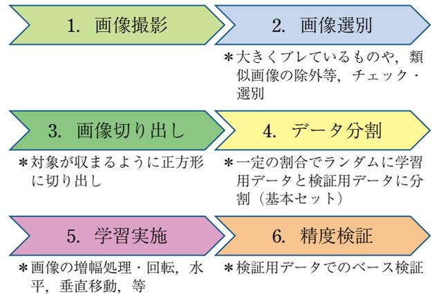
図-10 AI 識別モデル開発の基本的流れ
