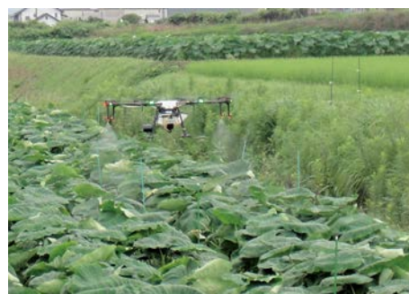
図-2 産業用マルチローターを使用したサトイモの防除試験
