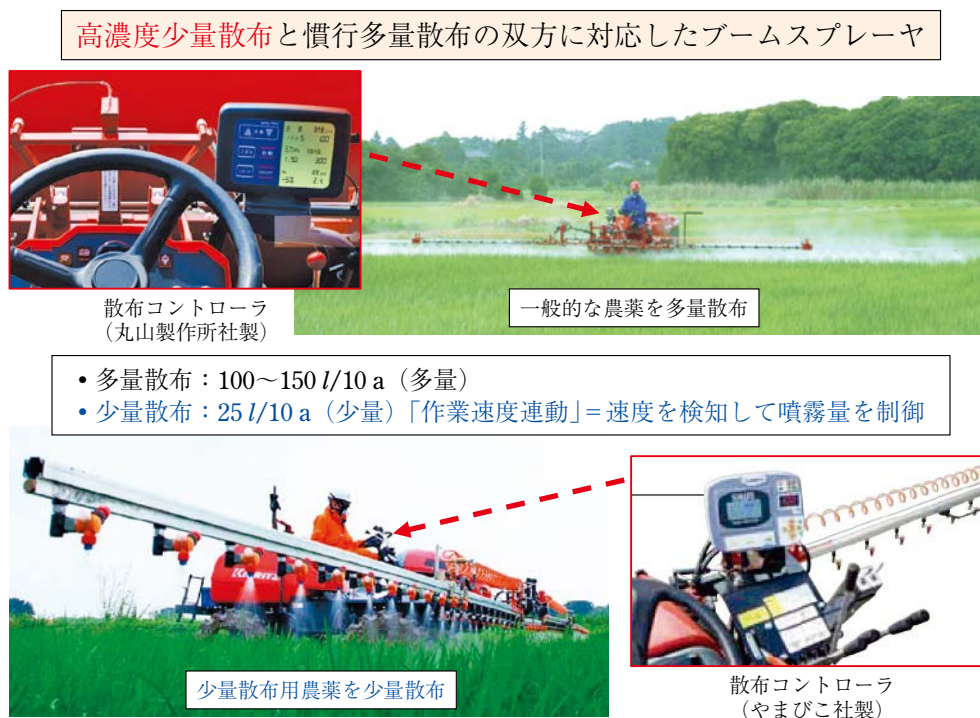
図-3 開発した環境保全型汎用薬液散布装置
