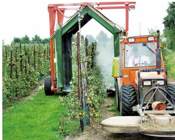
図-4 欧州での果樹における少水量高濃度散布 バイエルクロップサイエンス株式会社提供.
