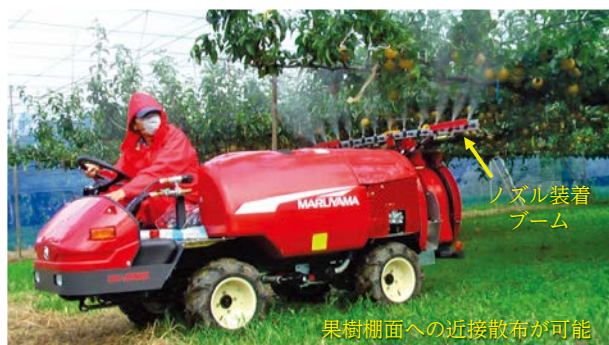
図-5 開発した棚栽培果樹用の棚用防除機
