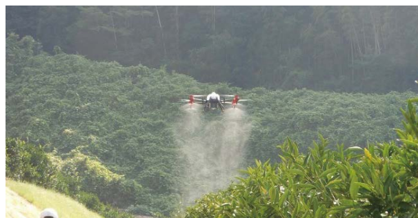
図-2 かんきつ園でのドローンによる農薬散布
