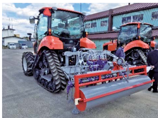
図-2 対抗植物および防除機器(左:対抗植物〈トマト野生種〉,右:土壌消毒剤灌注機器)
