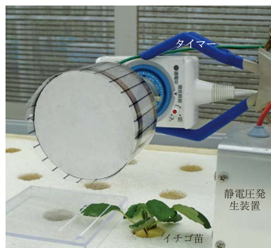
図-1 イチゴうどんこ病菌(KSP-7N)の単一菌叢から放出される子孫孢子を連続回収するため、温室内に設置された静電気孢子回収装置(静電ドラム)
