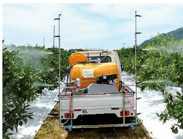
図-2 軽トラアタッチメント式防除機
